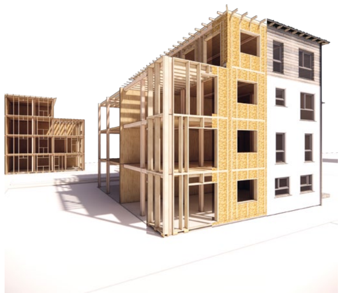
Bild 10 Brettsperrholz für die tragenden und raumabschließenden Bauteile, Brettschichtholz für Stützen und Unterzüge; sägeraues Schnittholz zur Herstellung der nichttragenden strohgedämmten und direkt verputzten Außenwandgefache
